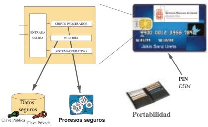
to seguro de información. La diferencia con las tarjetas normales estriba en que éstas tienen una banda magnética en la que existe cierta información, mientras que las tarjetas inteligentes disponen de un chip empotrado en la propia tarjeta.
