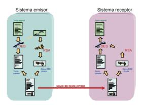
Figura 6. Algoritmo RSA de encriptación
