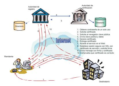
Figura 7. Proceso de transferencia de mensajes con PKI
