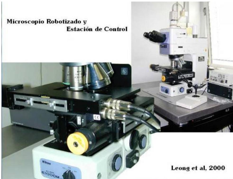
Figura 1. Microscopio robotizado y estación de control.
