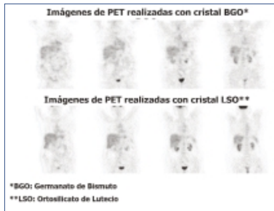
Figura. 4. Imágenes de PET realizadas con diferentes cristales de centelleo. Arriba BGO y abajo LSO. Se aprecia una mejor resolución espacial en las imágenes practicadas con LSO.
